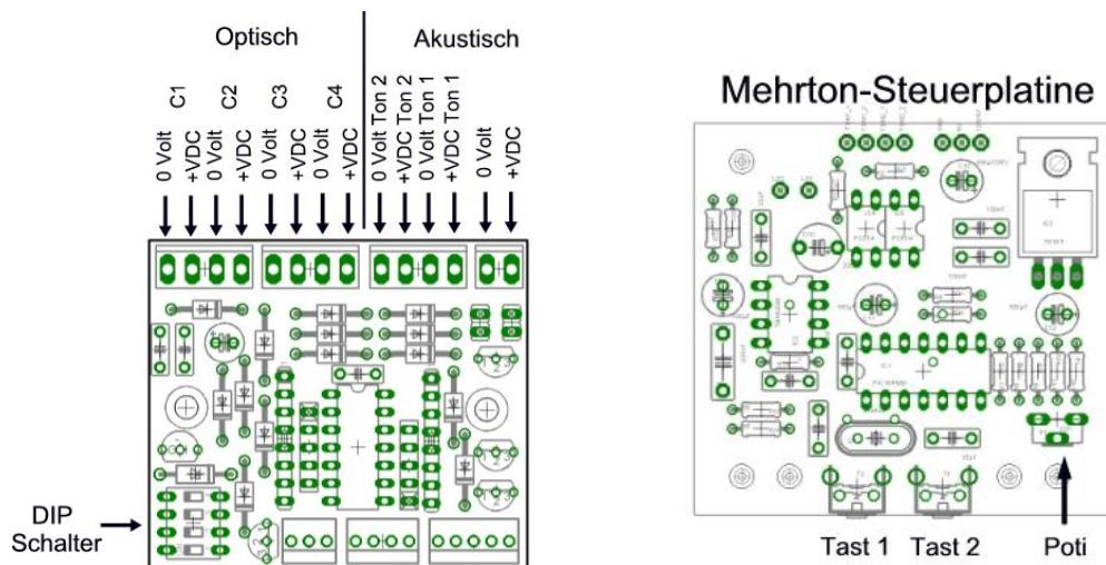
**Akustisch:** Ist eine permanente Betriebsspannung vorhanden, ist diese an 0 Volt und + VDC anzuschliessen. Ton 1 und Ton 2 können nun mit +24 VDC über die Eingänge +VDC Ton 1 und +VDC Ton 2 angesteuert werden. Die Strombelastung an den Steuereingängen beträgt hierbei ca. 10 mA.
